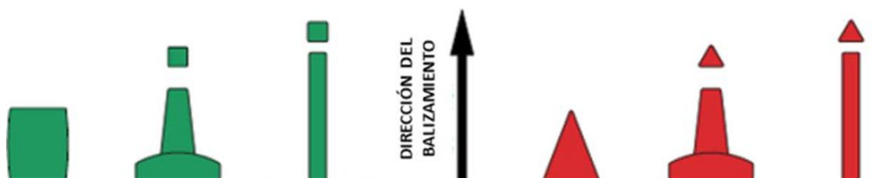
Figura 2 Marcas laterales utilizadas en la Región B
