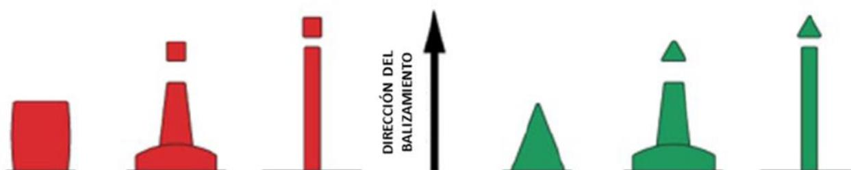
*Figura 1 Marcas laterales utilizadas en la Región A*
