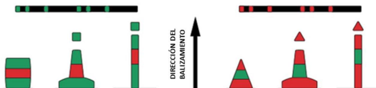
Figura 4 Marcas de canal principal utilizadas en la región B
